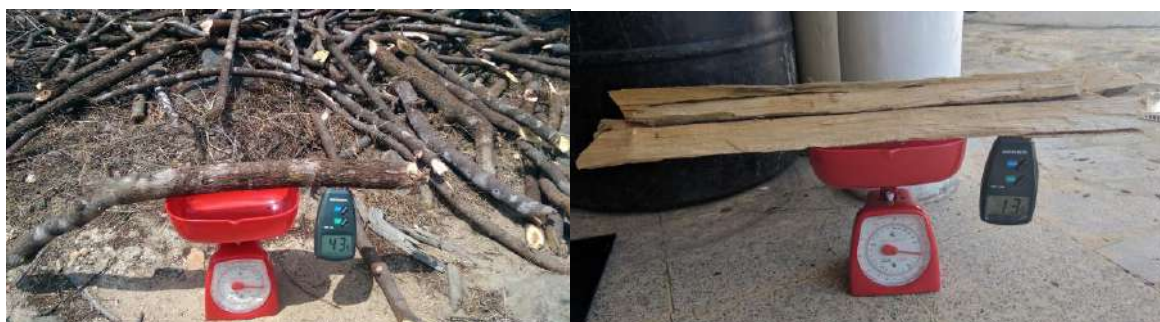
Figura 23: diferencia del 30% de humedad en los prototipos luego de 11 días de su extracción
