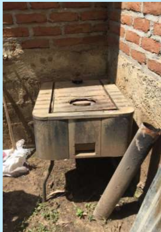
Figura 5. Estufa modelo Envirofit en desuso por deterioro.
